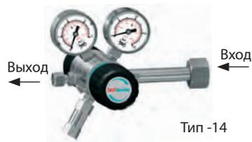
**Двухступенчатые, для инертных, реактивных, горючих и окисляющих газов и смесей, кроме кислорода, чистота макс. 6,0, давление в баллоне 315 бар/ 4500 фунтов/кв. дюйм, диапазон давлений на выходе 0,2 - 10,5 бар/ 3 -150 фунтов/кв. дюйм**
