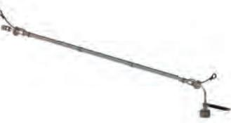
Согласно DIN 477/ 230 бар, с шестигранной гайкой. Материал нерж. сталь/ПТФХЭ. Вход см. ниже, выход M14x1,5f мм или NPT 1/4"m– с накидной гайкой. Гибкая гофрированная труба оснащается предохранительным тросом, который предотвращает биение в случае разрыва рукава. Преимуществом гофрированной трубы является максимальная гибкость в отношении газоснабжения. Соединения для баллонов согласно другим стандартам, в частности, AFNOR, NEN, ... и модели с баллонами на 315 бар по запросу.
