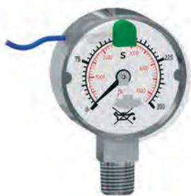
**Контактный манометр с индуктивным контактом (KI), для визуальной и звуковой сигнализации низкого давления подачи газа и контроля давления в баллонах; для инертных, горючих, окисляющих и коррозионных газов и смесей, номинальное давление макс. 300 бар**
