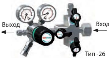
**Одноступенчатые, с продувкой инертным газом, для реактивных, горючих, окисляющих и коррозионных газов, кроме кислорода чистота макс. 6,0 давление в баллоне 230 бар диапазон давлений на выходе 0,5 - 200 бар / 7 - 2900 фунтов/кв.дюйм**
