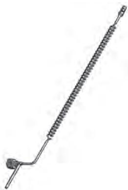
В соответствии с DIN 477/ 230 бар, трубка диам.1/8", с шестигранной гайкой, выход NPT ¼"m. Материал нержавеющей сталь/ ПТФХЭ. Соединения для баллонов согласно другим стандартам, в частности, AFNOR, NEN, ... по запросу.
